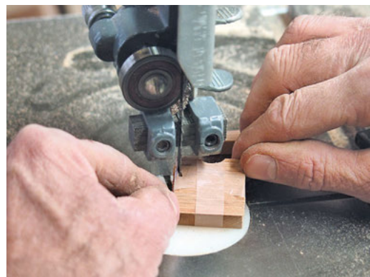
Mit der Bandsäge kann man nicht nur Bohlen auftrennen und Rohholz zuschneiden, mit einem Schweifband ist sie auch in der Lage, gebogene Linien in Vollholz zu sägen.
