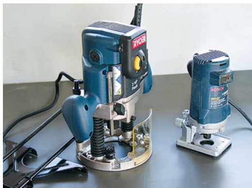
Die Handoberfräse (links) und die Kantenfräse sind bei der Herstellung von Holzkästen nützliche und wichtige Werkzeuge.
