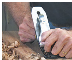
27 Bretter mit dem Handhobel bearbeiten
