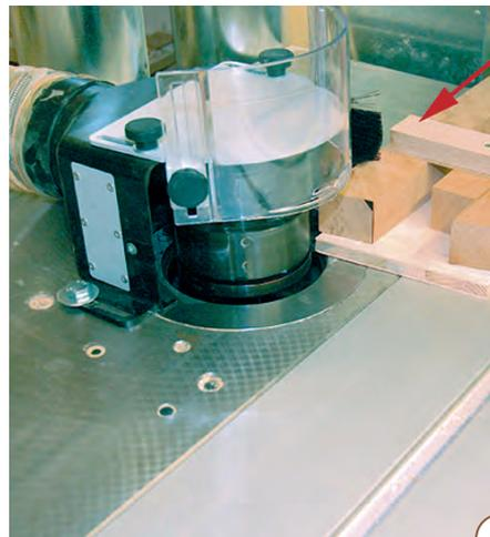
6 > Die Werkstücke werden durch die beiden Klemmleisten (Pfeil) auf die Frässchablone gepresst, so können sie nicht verrutschen. Am Frästisch ist ein Bogenfräsanschlagn mit Zuführleiste montiert, gefräst wird mit einem Falzkopf mit Anlaufring. Die Frässchablone wird an der Zuführleiste zum Fräswerkzeug geführt und dann am Anlaufring gehalten.
