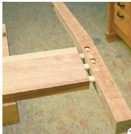
24 > Die Nuten für die Beschläge werden in zwei Tiefen und mit zwei verschiedenen Fräserdurchmessern gefräst. Dort, wo später die Schraubenköpfe sein werden, nehmen Sie einen Nutfräser mit 10 mm Durchmesser und fräsen etwas tiefer, aber nur in einem kurzen Bereich. Die Holzverbindung zwischen den Pfosten und den Unterteilen übernehmen Dübel.
