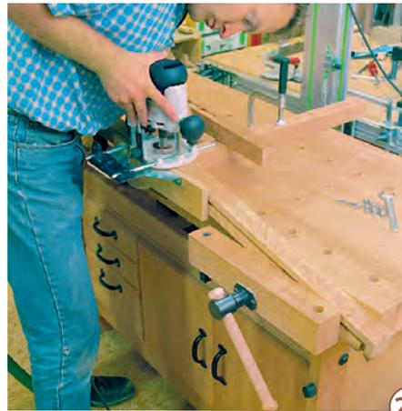
23 > Zum Einlassen der Beschläge nehmen Sie wieder die Oberfräse. Diese sollten Sie mit einem Nutfräser bestücken, dessen Durchmesser der Breite des Beschlages entspricht. Da die Kopfpfosten abgeknickt sind, müssen Sie diese mit Hilfe von Kanthölzern so einspannen, dass die Arbeitsfläche gerade liegt.
