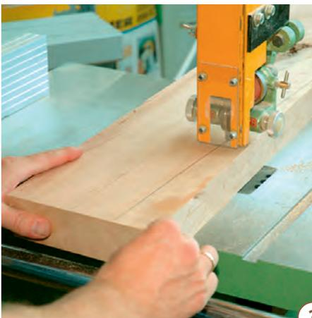
3 > An der Bandsäge werden die Kopfpfosten grob ausgesägt. Schneiden Sie circa 3 mm neben dem Riss, denn das exakte Format wird durch das Formfräsen erzeugt. Achten Sie bei der Bandsäge auf präzise Einstellung der oberen und unteren Bandführung sowie auf die richtig eingestellte Bandspannung. Für gerade Schnitte verwenden Sie ein 20 mm breites Sägeband.
