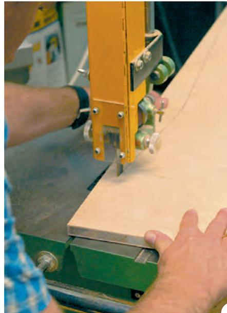
5 > An der Bandsäge wird die Kontur ausgesägt. Diesmal schneiden Sie so genau wie möglich am Riss, damit sparen Sie sich Nacharbeit. Die Kanten der Platten werden später am Koperring entlang geführt, also: Jede Unebenheit der Plattenkante, die hier entsteht, wird kopiert. Die Kanten sollten Sie also nachschleifen. Alternativ können Sie auch eine Handkreissäge mit Führungsschiene verwenden, damit werden die Schnitte exakt gerade.
