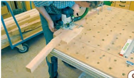
**9** > Mit einer handgeführten Oberfräse werden die Nuten (10 x 10 mm) zur Aufnahme des Kopfbrettes in die Innenflächen der Kopfpfosten gefräst.
