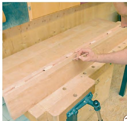
25 > Verbinden Sie das obere und untere Kopfteil mittels einer Lamello- oder Dübelverbindung, damit die Teile beim Verleimen nicht verrutschen.
