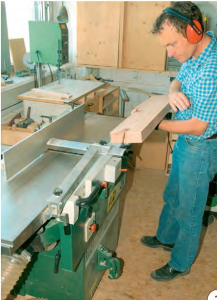
1 > Die grob formatierten Hölzer für die Kopfpfosten werden an der Abrichte plan und anschließend auf Dicke gehobelt. Dazu wird an der Kombimaschine der Dickentisch verwendet. Richten Sie deshalb nur eine Fläche ab, versuchen Sie nicht, mit der Abrichte Hölzer auf Dicke zu hobeln: Das funktioniert nicht! Überprüfen Sie die Oberfläche. Ist sie eingegrissen, so drehen Sie das Werkstück, damit Sie in Faserrichtung arbeiten.
