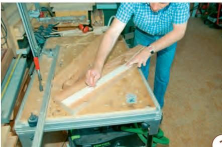
2 > Mit der aus der Zeichnung erstellten Schablone M 1:1 für die Kopfpfosten wird deren Kontur auf die Rohlinge übertragen. Achten Sie dabei darauf, dass Holzfehler wie Risse oder Äste möglichst wegfallen.
