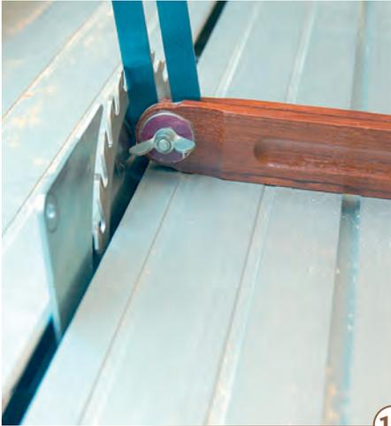
17 > Da sich der Frästisch der Oberfräse nicht schräg stellen lässt, stellen Sie die Nut an der Tischkreissäge her. Das Sägeblatt wird mit Hilfe der Schmiege schräg eingestellt. Der Oberschutz muss abgenommen werden, da es sich hier um einen verdeckten Schnitt handelt (Nach Beendigung sofort wieder Schutzhaube montieren!). Außerdem müssen Sie den Spaltkeil unter die Sägeblatthöhe senken.
