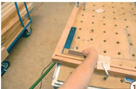
**11** > Zur Aufnahme des abgewinkelten Kopfbrettes muss die Nut oben rechtwinklig nach hinten verlaufen. Für eine durchgehende Führung des Seitenanschlages der Oberfräse spannen Sie den zweiten Kopfpfosten als Hilfe rechtwinklig auf.
