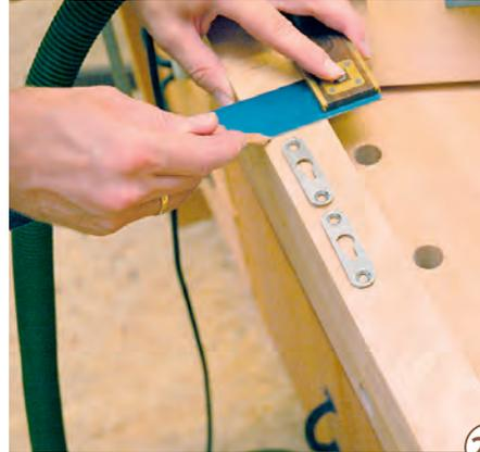
22 > An den Vorderflächen der Kopfpfosten und natürlich auch bei den Fußpfosten wird die Position der Bettbeschläge markiert. Dazu zeichnen Sie die Position der Seiten auf und platzieren Sie die Beschläge innerhalb dieser Markierungen. Übertragen Sie diese Position exakt auf die anderen Pfosten.
