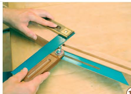
**16** > Der untere Falz des Kopfbrettes wird mit dem Kopfstück-Oberteil verbunden. Dessen obere Fläche benötigt deshalb eine schräg eingesägte Nut. Die Schräge entspricht dem Knick des Pfostens. Nehmen Sie sie vom Kopfpfosten mit Anschlagwinkel und einer Schmiege ab.
