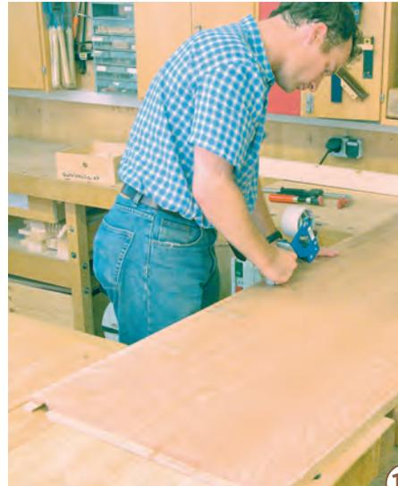
**14** > Nach dem Falzen wird das obere Winkelstück an der Tischkreissäge mit zwei 45°-Gehrungsschnitten so abgetrennt, dass es anschließend als Winkel wieder angeleimt werden kann. Das Winkelstück wird mit Hilfe von transparentem Paketklebeband mit dem Kopfbrett verbunden, dazu legen Sie die Teile mit der Vorderseite nach oben. Drehen Sie sie anschließend um, geben Sie gleichmäßig Leim an, klappen Sie das Winkelstück um und fixieren Sie es ebenfalls mit Klebeband.
