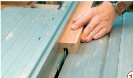
18 > Sägen Sie erst die beiden äußeren Kanten und räumen dann die Nut aus. Das erfordert mehrere Durchgänge.
