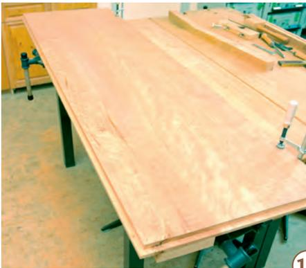
19 > Hier das fertig gefalzte Kopfbrett. Jetzt muss geprüft werden, ob Nut und Federn zusammen passen.
