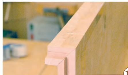
**15** > Hier sehen Sie den oberen Abschluss des Kopfbretts. Nach dem Trocknen des Leims entfernen Sie die Klebestreifen, sägen die Platte auf Breite und fräsen erst jetzt den unteren Falz (siehe auch Bild 19).
