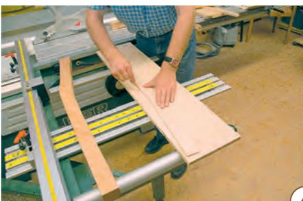
4 > Für die Klemm-Frässhablone zum Formfräsen nehmen Sie eine Platte (950 x 250 x 15 mm) und zeichnen Sie die vordere und hintere Kontur der Kopfpfosten mit größerem Abstand auf.
