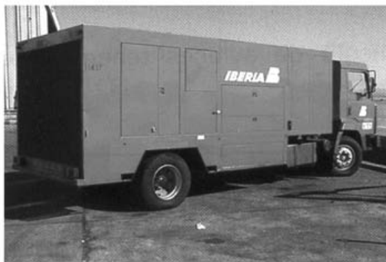
Figura – Equipo de aire acondicionado para servicio en tierra.
