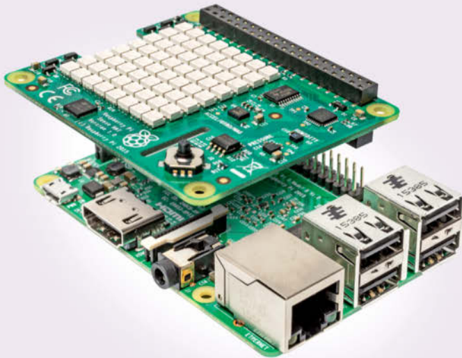
Fast alle Erweiterungskarten lassen sich - genau wie dieses Sense-HAT - einfach auf den Raspi stecken.
