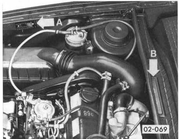
Das Typschild –A– befindet sich im Motorraum am rechten Seitenteil.
