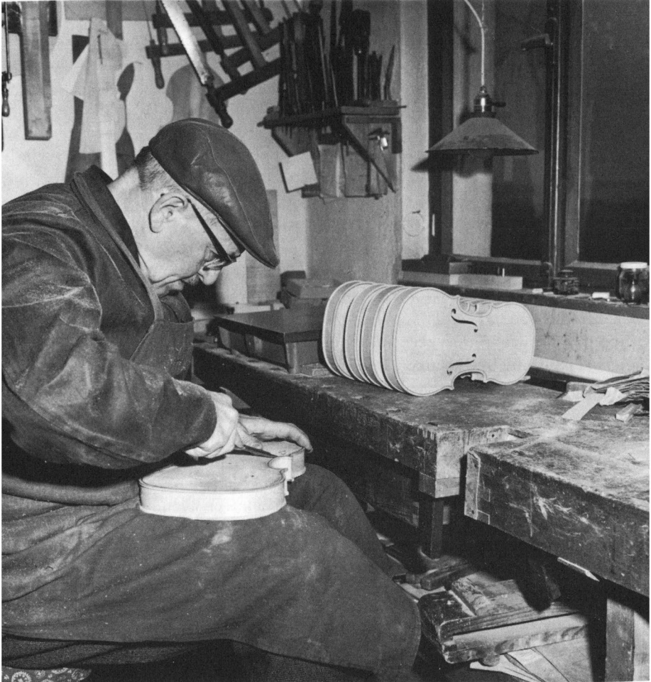
Geigenbauer beim Stechen der Hohlkehle (Werkstätte Hopf, Wehen. Foto Klaus Grandpierre)
