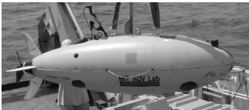
Figure 1.3. The MIT underwater vehicle: Odyssey II, Xanthos
