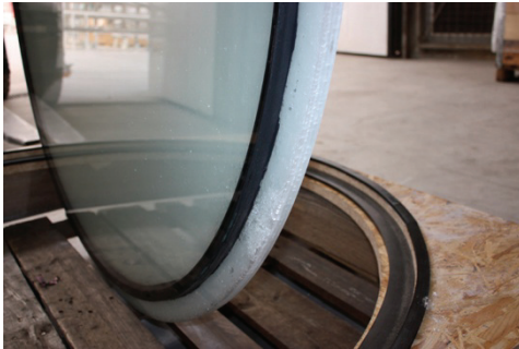
Bild 2-4 Versuchskörper für die Begutachtung des Resttragverhaltens © seele_sedak
