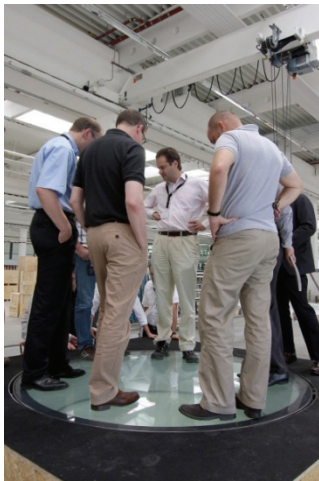
Bild 2-3 "Belastungstest" im Werk von seele_sedak © schneider+schumacher
