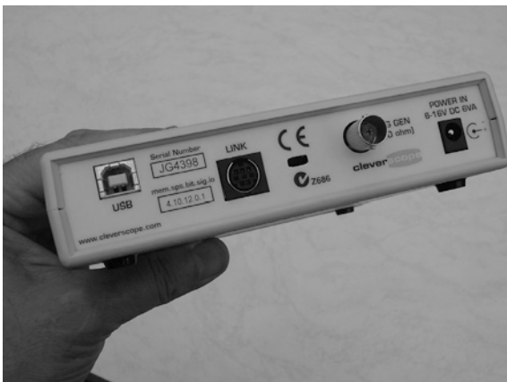
Abb. 23.3: An der Rückseite befinden sich (von links) USB-Buchse, Link-Buchse (I/O), Signalgenerator- und Netzteilbuchse
