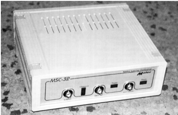
Abb. 5.9: Das Metec MSC-32 – ein Vorläufer des USB-Scopes
