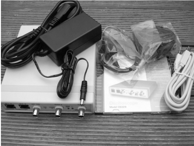
Abb. 23.1: Das CleverScope 328 mit Netzteil, Anschlüssen für die Digitalbuchsen und CD
