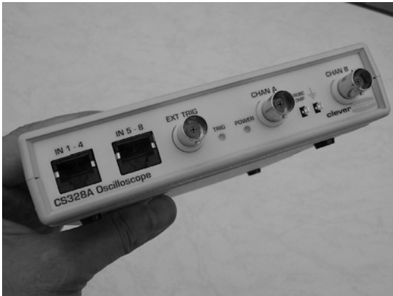
Abb. 23.2: Blick auf die Vorderseite: links die beiden Buchsen für je vier digitale Signale
