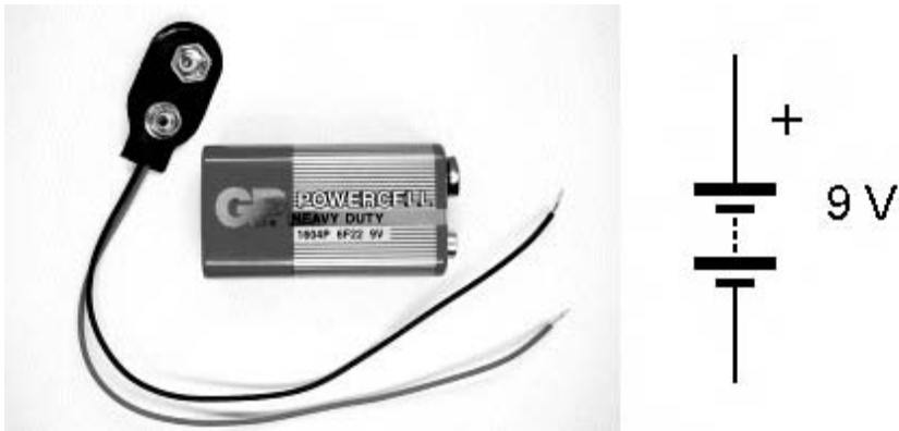
Abb. 1.3 Die Batterie real und als Schaltsymbol
