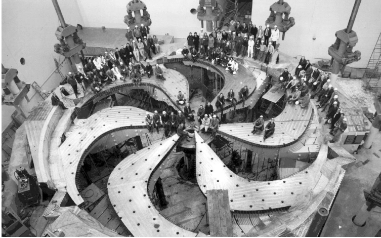
Abbildung 2.8: Untere Hälfte des Hauptmagneten des Zyklotrons am TRIUMF, Vancouver (mit freundlicher Genehmigung des TRIUMF).
