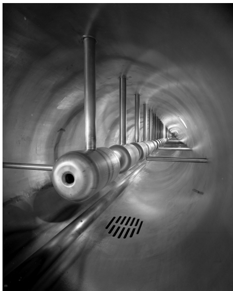
Abbildung 2.4: Der Protonenlinearbeschleuniger des Fermi Laboratory (nahe Chicago, Illinois). Die Hochspannungen werden von oben und links zugeführt (Photo Fermilab).
