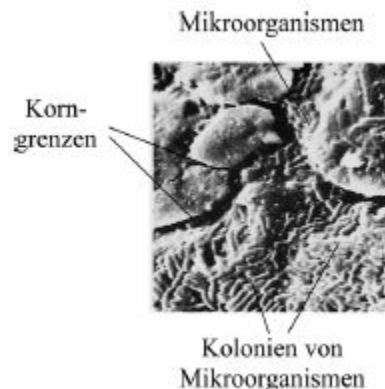
Abb. 1.5 Besiedlung durch Mikroorganismen auf einer Edelstahloberfläche.
