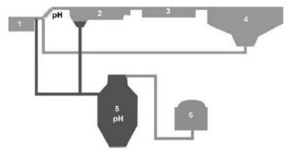
Abwasserreinigungsanlagen schützen die Gewässer vor Einleitungen ungereinigter Abwässer und somit vor extremen pH-Änderungen. Bereits bei Werten unter pH = 6,5 besteht die Gefahr von Betonschäden in der Kanalisation. Bei Werten unter pH = 5 und über pH = 10
