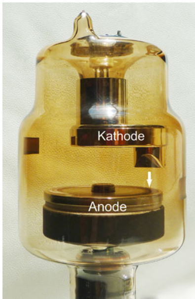
■ Abb. 1.1 Foto einer älteren, ausgedienten Röntgenröhre. Man kann auf dem Anodenteller deutlich den Brennring sehen (durch permanente Drehung des Anodentellers wird eine punktuelle Überhitzung des Brennpunktes vermieden. Die aufschlagenden Elektronen führen zu einer Erosion, die als dunkler Streifen auf dem Anodenmaterial sichtbar wird)
