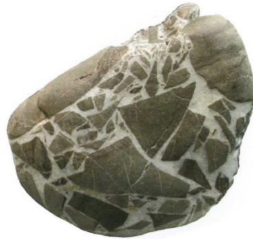
Bild 1-3 Störungsbreccie (hellgraue Dolomitbruchstücke in weißer Dolomitmatrix) [12]
