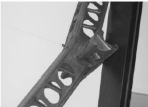
Abbildung 3 Knoten zwischen räumlichem Ring- und Längsträger in geklebter Holzbauweise. Bauart Schütte-Lanz um 1915
