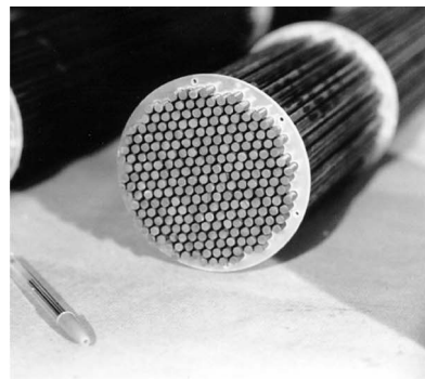
Bild 6: CFK-Paralleldrahtbündel mit 241 CFK-Drähten und 1.2 MN Traglast
