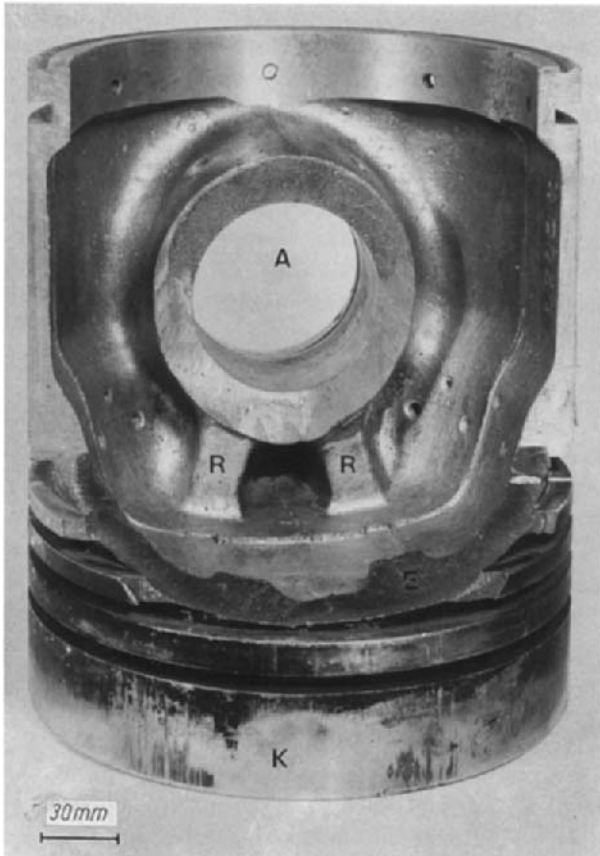
Bild 2.8 Schadhafter Kolben aus einem Dieselmotor A Kolbenbolzenauge; E Ermüdungsbruchfläche; K Kolbenkopf; R Rippen Kolbendurchmesser 200 mm
