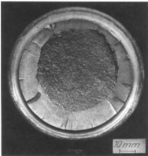
Bild 2.5 Ermüdungsbruchbild einer Straßenbahnachse (Die Aufnahme wurde von der Ingenieurschule für Verkehrstechnik Dresden zur Verfügung gestellt.)
