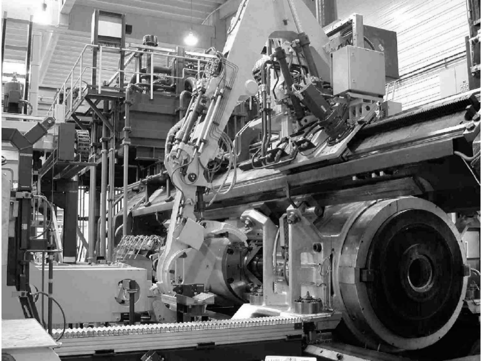
Bild 4: 75 MN Indirekt/Direkt-Strang- und Rohrpresse – Otto Fuchs Meinerzhagen
