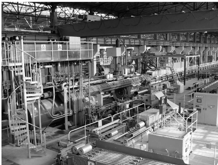
Bild 2: 45 MN Indirekt-Rohrpresse – Northwest Aluminium China.
