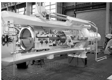
Bild 6: 10 MN Indirekt- Rohrpresse mit integriertem, innenliegenden Lochzylinder
