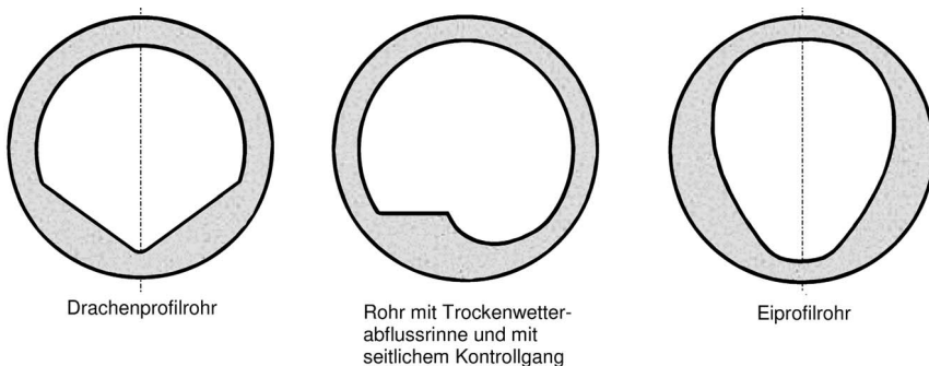
Bild 1.3. Beispiele für nicht genormte Stahlbeton-Profil-Vortriebsrohre mit kreiszylindrischer Außenkontur
