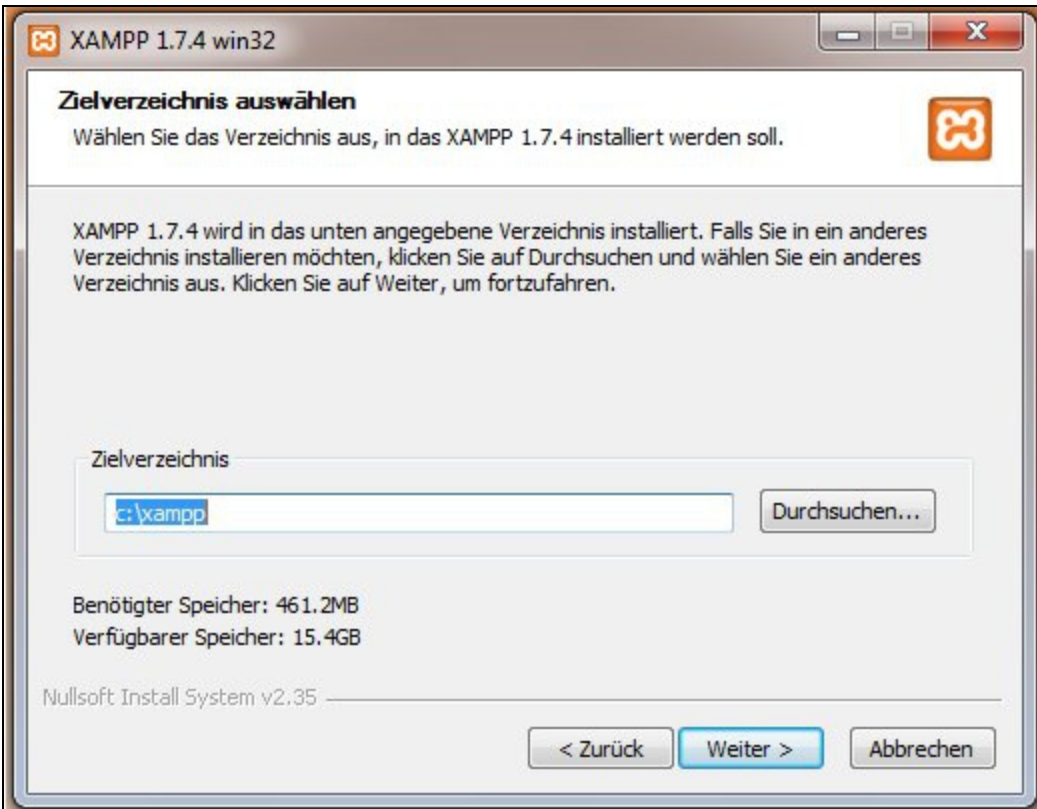
Bild 2.4 Festlegen des Installationsverzeichnisses
