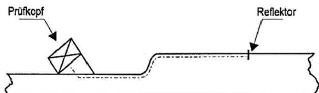
Abb. 1.8 Nachweis von Oberflächenrisen mit Hilfe von Oberflächenwellen [1.2]
