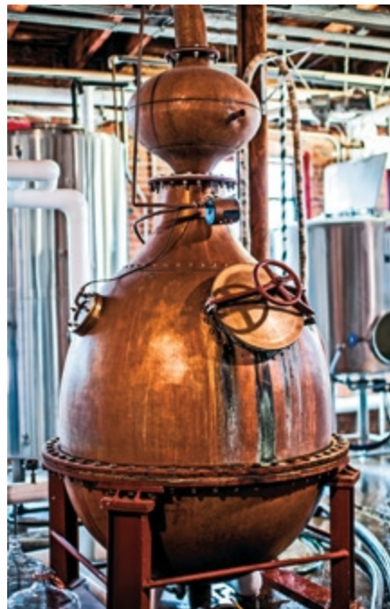
Eine kupferne Pot Still mit ungewöhnlicher Form. Kupfer ist eines der wichtigsten Metalle beim
