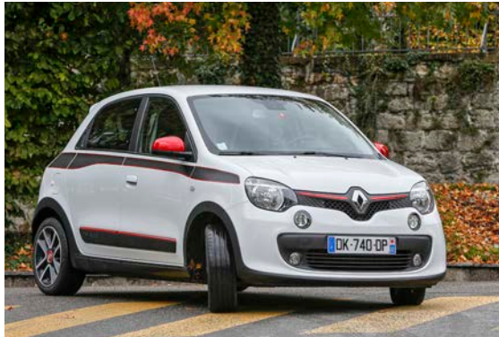
Der neue Renault Twingo teilt die Basis mit dem Smart Forfour, hat also Heckmotor und Heckantrieb. La nouvelle Renault Twingo partage sa plateforme avec la Smart Forfour, toutes deux à propulsion et moteur arrière.
