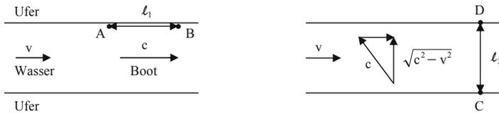
Abb. 1.3 Ein Boot fährt in Flussrichtung (links) und quer dazu (rechts)
