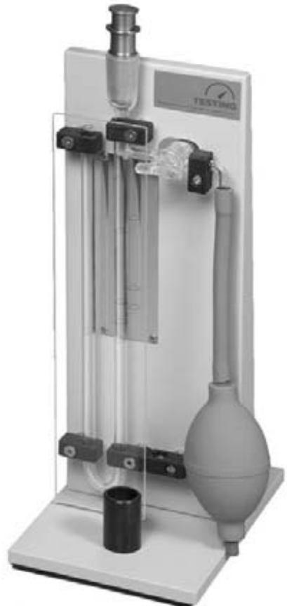
Bild 3.1: Manuelles Luftdurchlässigkeitsgerät nach Blaine
