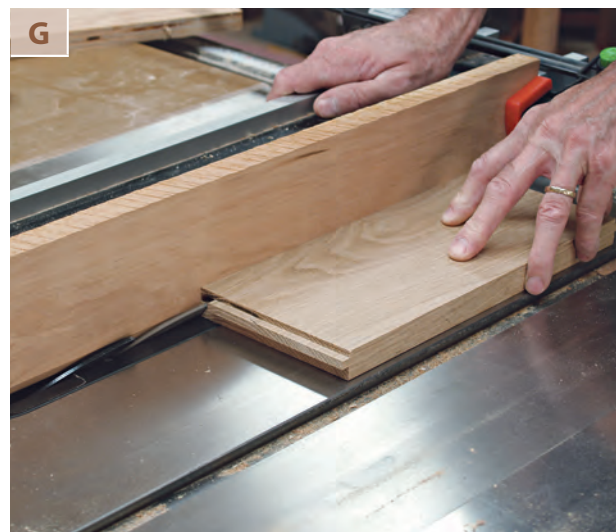
SÄGEN SIE QUER ZUR AUFHÄNGERUNTERKANTE eine 35°-Fase. Der Aufhänger liegt dazu mit seiner Rückseite flach auf dem Sägertisch.
