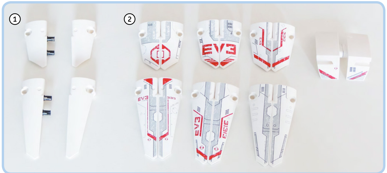
Abbildung 1-5: Um die Aufkleber passend auf die Paneele zu kleben, fügst du zuerst zusammengehörige Elemente mittels zweier schwarzer Pins zusammen, sodass sie besser ausgerichtet werden können. Anschließend entfernst du die Pins.
