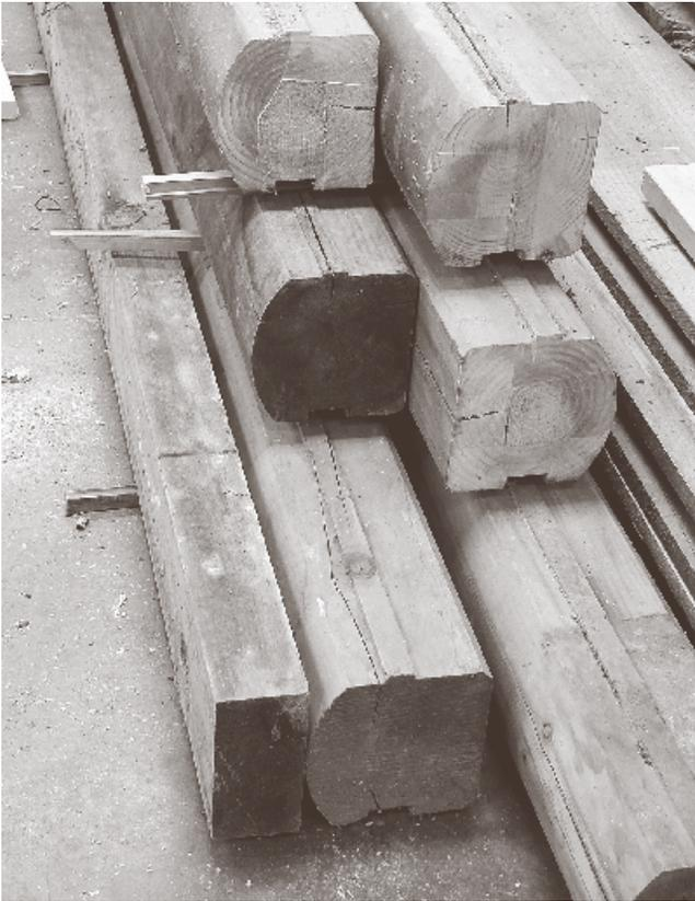
**Material für die Bank:** Eine schwere Platte halte ich für die Grundlage jedes guten Hobelbankentwurfs. Diese 175 x 175 mm dicken Abschnitte eines Blockhauses sind ideales Material für eine Hobelbank.
