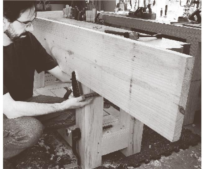
**Sie sind nicht so eitel:** Versuchen Sie dies einmal mit einer Bank, die jede Menge Schubkästen unter der Platte hat. Vielleicht funktioniert es, vielleicht nicht. Dies hier wird immer funktionieren. Ihre Beine und Riegel sind 1A Flächen zur Befestigung mit Zwingen. Lehnen Sie die nicht ab.
