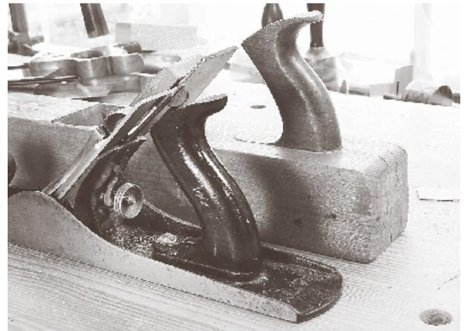
**Große hölzerne Kerle:** Der Holzkörper meiner Raubank hat einen Querschnitt von 60 x 75 mm. Bei dem Metallhobel liegt die Hand am Griff nur wenige Millimeter über der Bankplatte. Das macht einen Unterschied.
