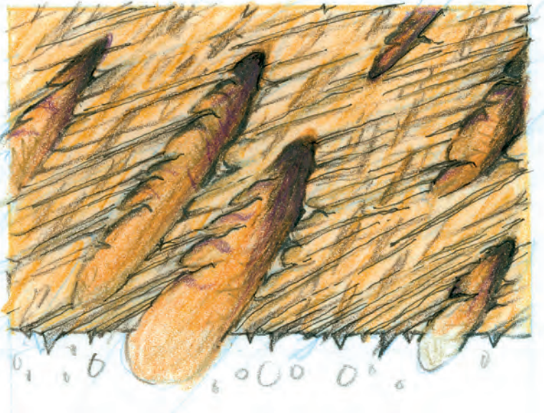
Abb. 1-3 Eine geschliffene Holzoberfläche ist durch tiefe Furchen und zerrissene Fasern gekennzeichnet. Beim Schleifen werden die Fasern der Holzoberfläche zerrissen, während die Bearbeitung mit der Ziehklinge zu einer geringeren Anzahl gerissener Fasern führt, die meist länger sind.
