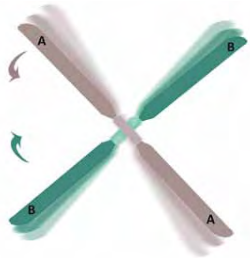
Abbildung 6.3 – Grafische Draufsicht auf die beiden gegenläufigen Rotorebenen (Grafik: Melanie Breuers)
