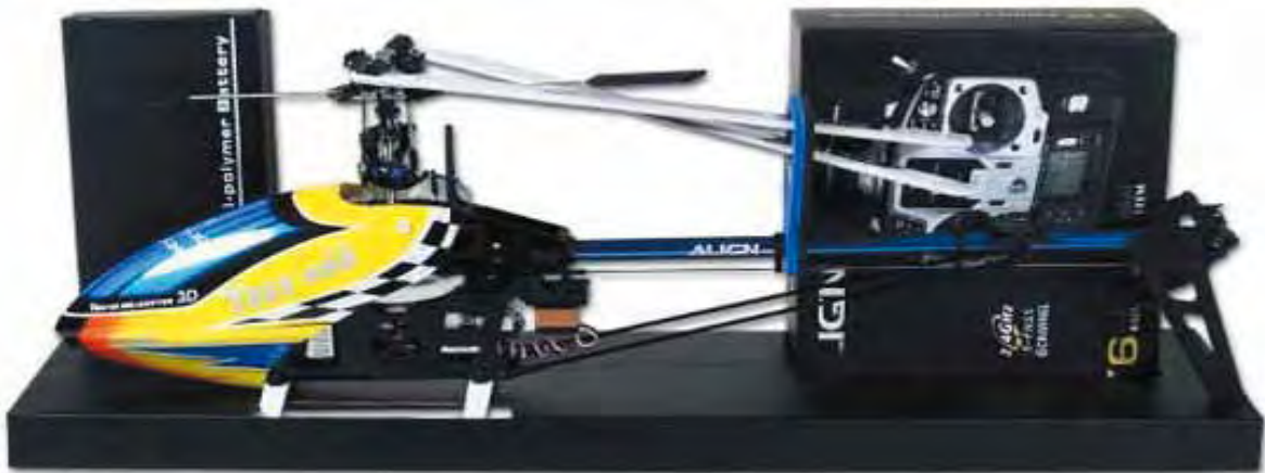
Abbildung 6.14 – T-Rex-450-Plus -RTF-Set von Robbe/Align, bestehend aus: T-Rex , Sender T6J von Futaba, Flugakku, Ladegerät Power Peak A4 . Einstellungen überprüfen, ggf. anpassen und ab geht's!
