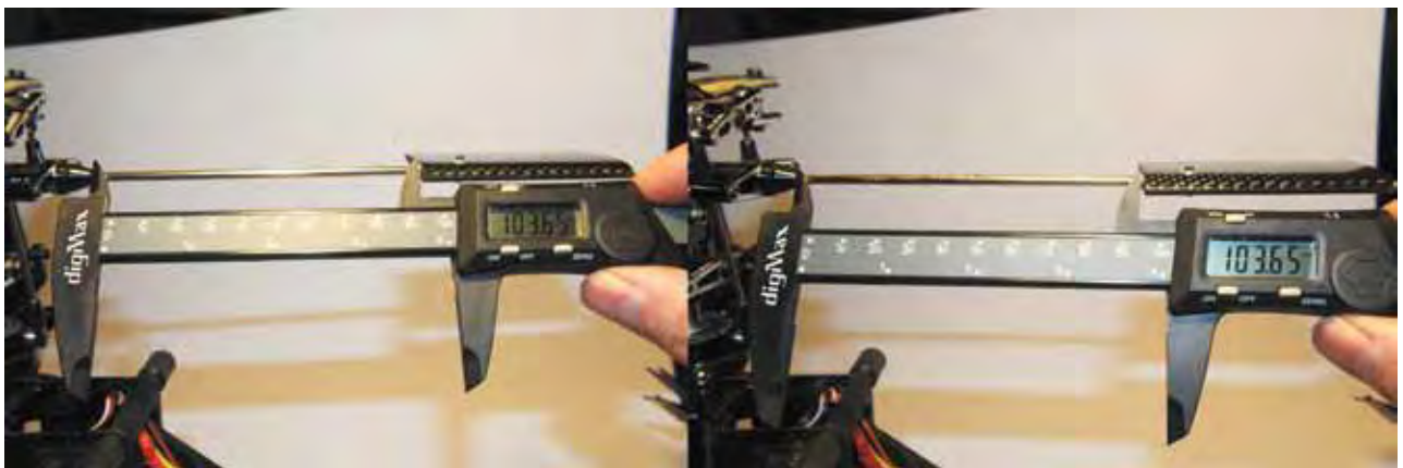
Abbildung 12.1 – Messen des Abstandes von der Paddelwippe zum Paddel – beide Seiten müssen exakt den gleichen Abstand haben, damit du mehr Laufruhe am Rotorkopf erhältst.
