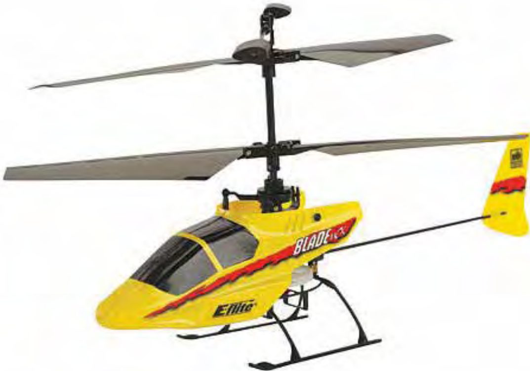
Abbildung 6.2 – Blade MCX von Horizon Hobby – ein sehr gutmütiger 4-Kanal-Koaxial-Heli
