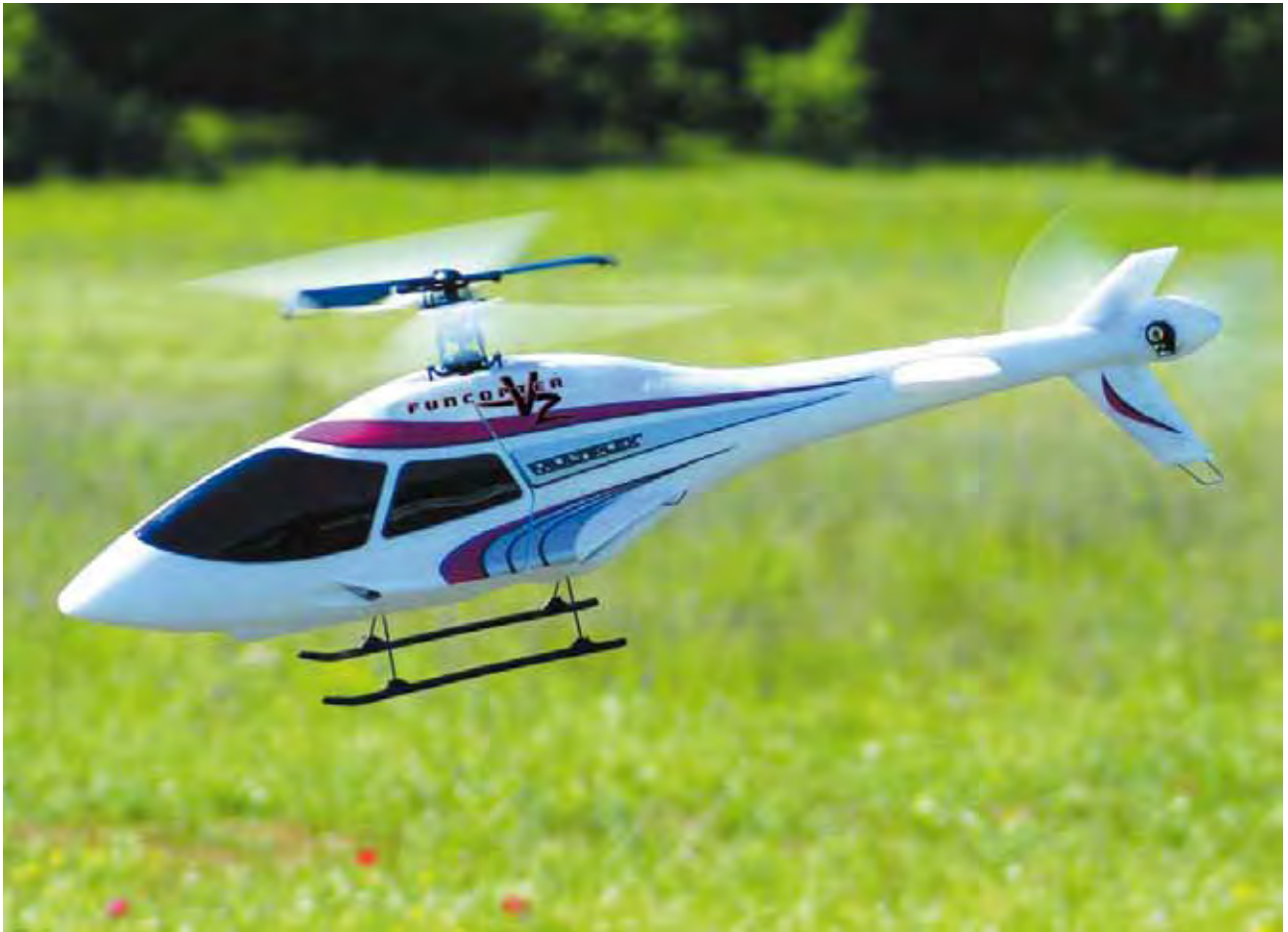
Abbildung 6.8 – Der FunCopter V2 beim Rundflug. Der Heli ist drehzahlgesteuert und hat 4 Kanäle. Die Verkleidung ist aus sehr robustem EPP und steckt auch so manche Springboden-Attacke weg. (Quelle: www.multiplex-rc.de )
