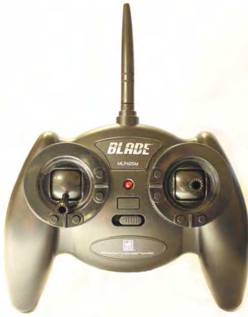
Abbildung 6.12 – Der Sender des RTF-Komplettsets (MLP4DSM 4-Kanal DSM2). Sieht fast so aus wie ein Konsolen-Controller und fliegt sich auch so – nur dass es keine »Reset-Taste« für den Neustart gibt.
