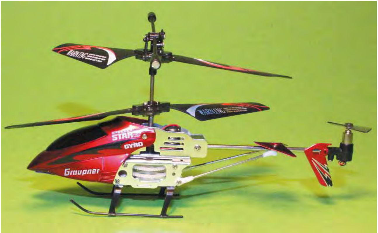
Abbildung 6.1 – 3,5-Kanal-Helikopter mit Infrarotfernbedienung von Graupner – hier fehlt die Steuerung über Roll. Nick wird über den hochstehenden Heckrotor realisiert.
