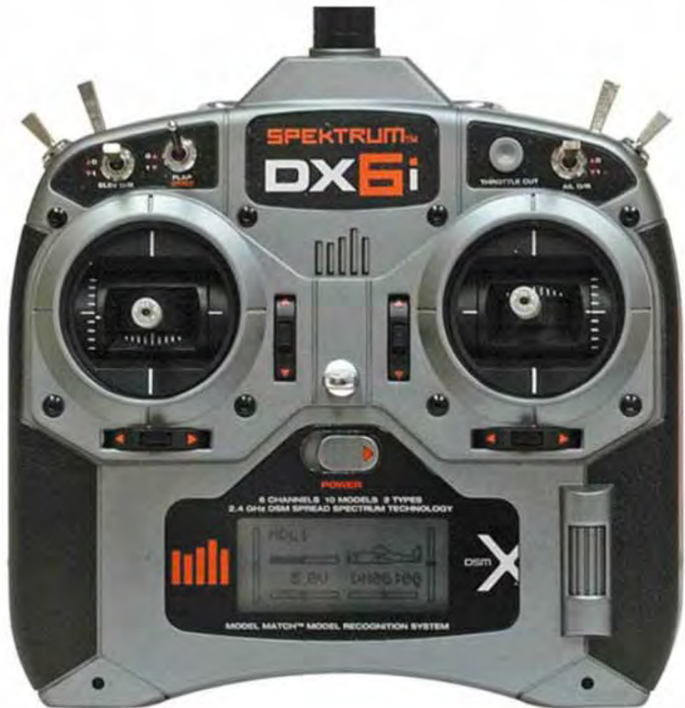
Abbildung 6.13 – Spektrum-Sender DX6i – Alle Modelle von Horizon Hobby aus den BNF-Sets kannst du mit diesem Sender fliegen. dein Vorteil: Hier kannst du auch »Expo« und »Dual Rate« einstellen. (Foto: www.horizonhobby.de )
