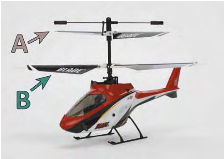
Abbildung 6.4 – Die beiden Rotorebenen laufen gegeneinander und heben so das Drehmoment auf. Hier ein Blade MCX2 von Horizon Hobby. (Quelle: www.horizonhobby.de )
