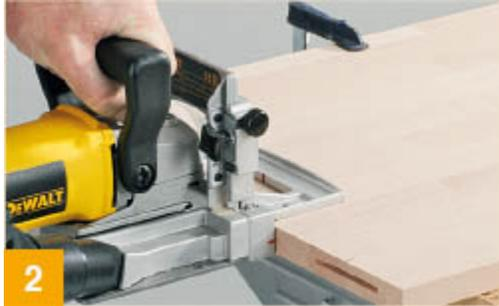
**Dann stellen Sie die Flachdübelfräse auf das Dübelmaß ein und fräsen Nuten erst in die Kopfholzfläche, dann in die Fläche (2).**
