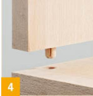
**Die Dübel werden unter Leimzugabe eingesetzt und die Bauteile bis zum Abbinden verpresst (4).**
