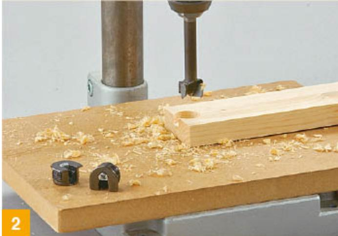
**Die Löcher für die Exzenterverbinder (hier: Sockel) werden mit dem 20-mm-Bohrer eingebracht (Abstände gemäß Anleitung)**
