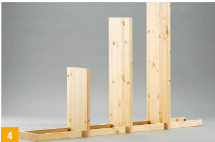
**Ein erster Zwischenschritt: Die aufrechten Wangen und die beiden Sockelleisten sind fertig mit den Exzenterverbindern montiert**
