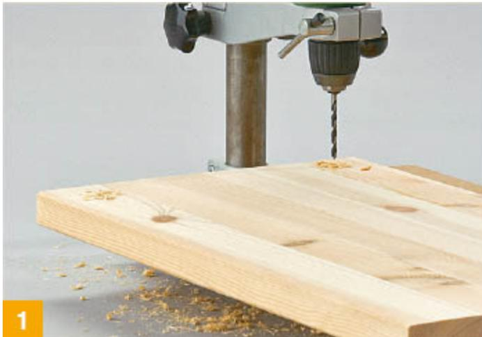
**Um die Seitenteile für den Sockel vorzubereiten, bohren Sie die aufrechten Wangen mit dem 5-mm-Holzbohrer für die Verbinder**
