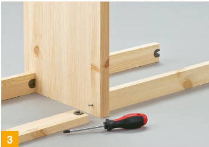
**Dann folgt das Zusammenstecken: Seitenteile und Sockelleisten werden zunächst probeweise mit den Beschlägen verbunden**
