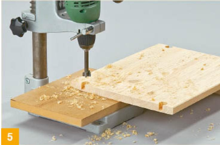
**Auch die Einlegeböden des Regals werden mithilfe eines 20-mm-Forstnerbohrers für das spätere Anbringen der Beschläge vorbereitet**
