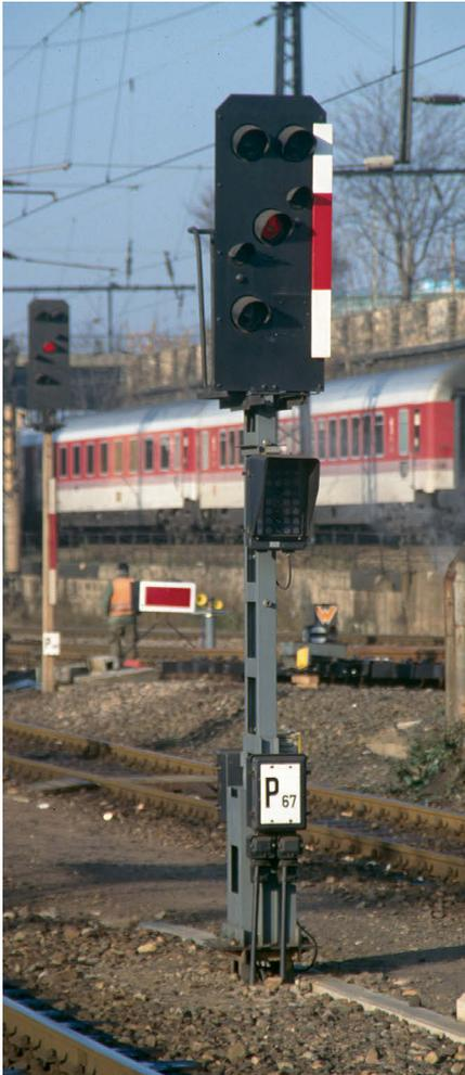
Das Mastschild darf auch am Signalschirm angebracht sein.
