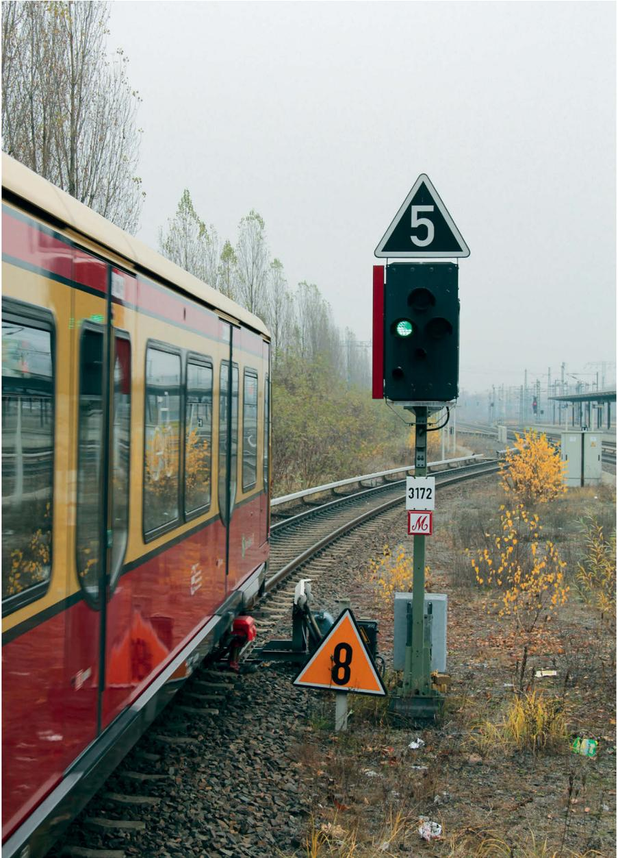
Das Signal 3172 trägt am Schirm das rote Mastschild.
