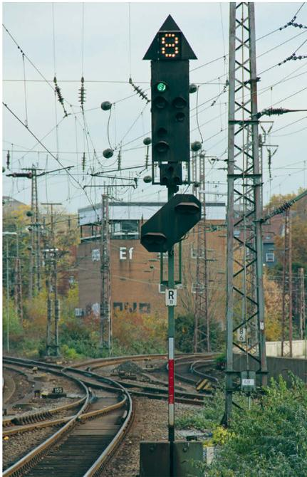
Fahrt mit höchstens 80 km/h. Das Vorsignal ist dunkel geschaltet, weil für die frei gegebene Richtung das Hauptsignal R ein Ausfahrtsignal ist, dem kein weiteres Hauptsignal folgt.
