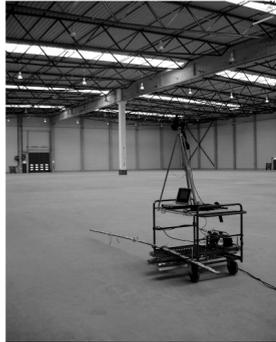
**Bild 13.** Hohlstellen-Kartierung einer 22.000 m<sup>2</sup> großen Hallenfläche mit der aktiven Infrarotthermografie
