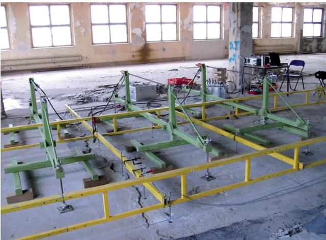
**Bild 14.** Versuchseinrichtung mit drei Lastrahmen (grün) und einer entkoppelten Messbasis (gelb) auf einer Stahlsteindecke. Die Lastrahmen ermöglichen bei statisch bestimmter Lagerung und jeweils acht weitgehend variablen Lasteinleitungspunkten eine sehr gleichmäßige Belastung der Prüffelder. Die Durchbiegungen werden mit induktiven Wegaufnehmern und die Lasten mit Kraftmessdosen aufgenommen
