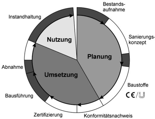
**Bild 3.** Qualitätskreis für Leistungen im Rahmen der Bauwerk-erhaltung – die Randstreifen markieren, wann physikalische Prüfungen durchzuführen sind
