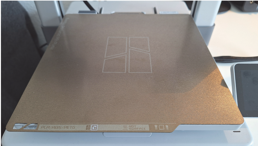
Abb. 2.5: Das Druckbett des Bambu Lab A1
