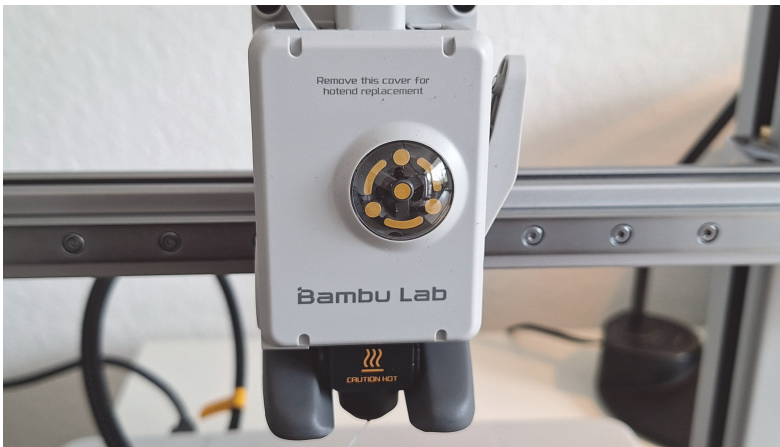
Abb. 2.2: Der Materialfeeder des Bambu Lab A1
