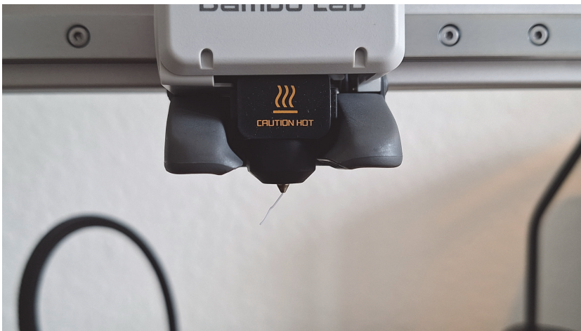
Abb. 2.4: Die Druckdüse (Extruder) des Bambu Lab A1
