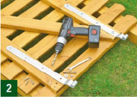
**Das Schraubensystem des Torbeschlags ermöglicht jederzeit ein Nachjustieren (auch nach Jahren noch)**
