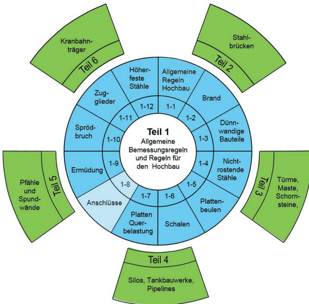
Bild I–1: Übersicht über die Normenteile von Eurocode 3 Bemessung und Konstruktion von Stahlbauten: Grundlagenteile 1-1 bis 1-12 und Anwendungsteile Teil 2 bis Teil 6
