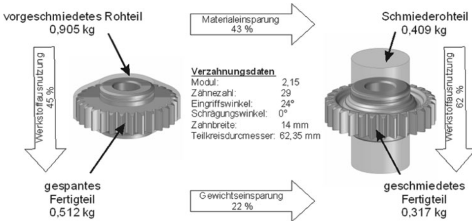
Abb. 2.1 Zahnradrohling geschmiedet aus dem Vollen gefräst [Lao97]
