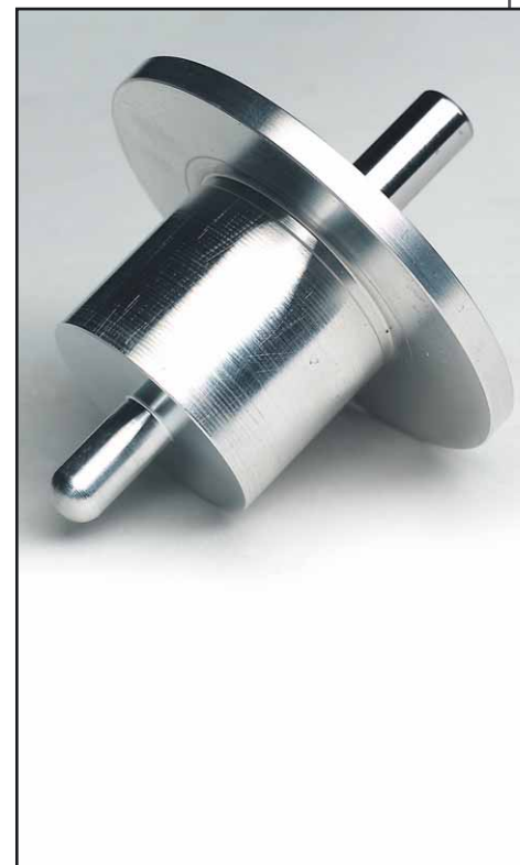
Die Tellerachse aus Stahl läuft auf einer Keramikugel, die Büchse des nicht-invertierten Lagers ist mit Sinterlagerbronze ausgekleidet
