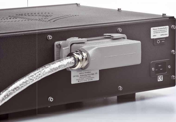
Das Netzteil wird mit über einen soliden Industriestecker mit dem Verstärker verbunden
