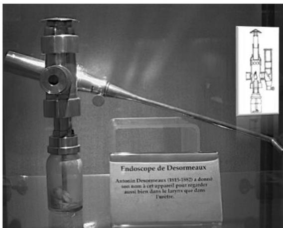
**Figura 1–2.** Endoscopio de Desormeaux y su mecanismo de iluminación.
