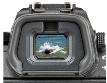
▲ Sucher der Nikon Z6III: Bildfeldabdeckung ca. 100 %, Vergrößerung ca. 0,8-fach.
