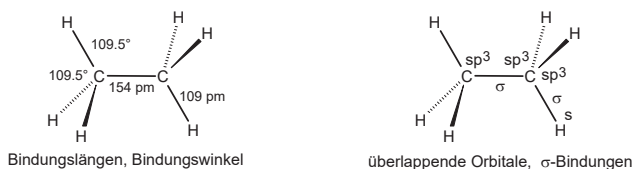
Abb. 4.2. Bindungslängen (Atomabstände), Bindungswinkel und σ-Bindungen des Ethans
