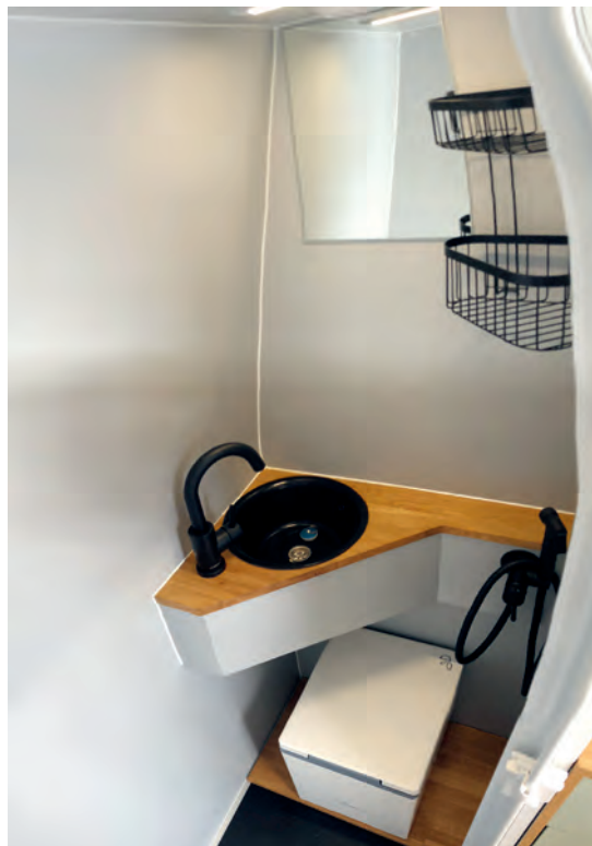
Eine Nasszelle muss dicht sein, die Silikonfugen sind hier gut zu erkennen.
