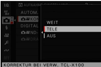
▲ Bei der Verwendung der älteren Konverterversion muss die Korrektur manuell im Kameramenu eingeschaltet werden.
