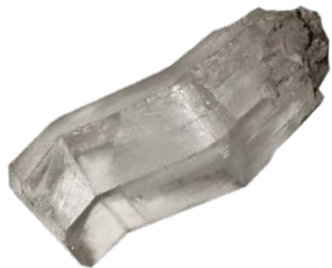
Gips-Kristalle lassen sich vorsichtig biegen, kehren aber nach der Biegung nicht mehr in die Ausgangsstellung zurück.
