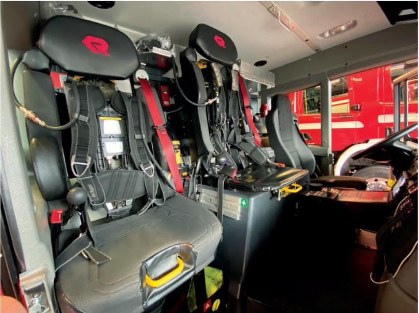
**Bild 1:** *Integrierte Pressluftatmer in einer Sondersitzanlage (Quelle: Schutz und Rettung Bern, Berufsfeuerwehr)*
