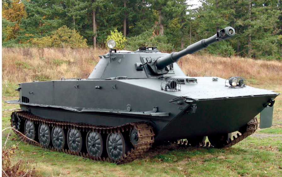
Der PT-76 setzte Anfang der 1950er Jahre Maßstäbe, da er Gewässer ohne Vorbereitung zu durchqueren vermochte. Dieser PT-76 befindet sich im Evergreen Air Museum, McMinnville, Oregon. (Foto: Greg Goebel, 2007)
