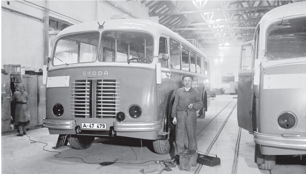
Fertigung von Stadtbussen Skoda 706 RO bei Karosa in Vysoke Myto.
