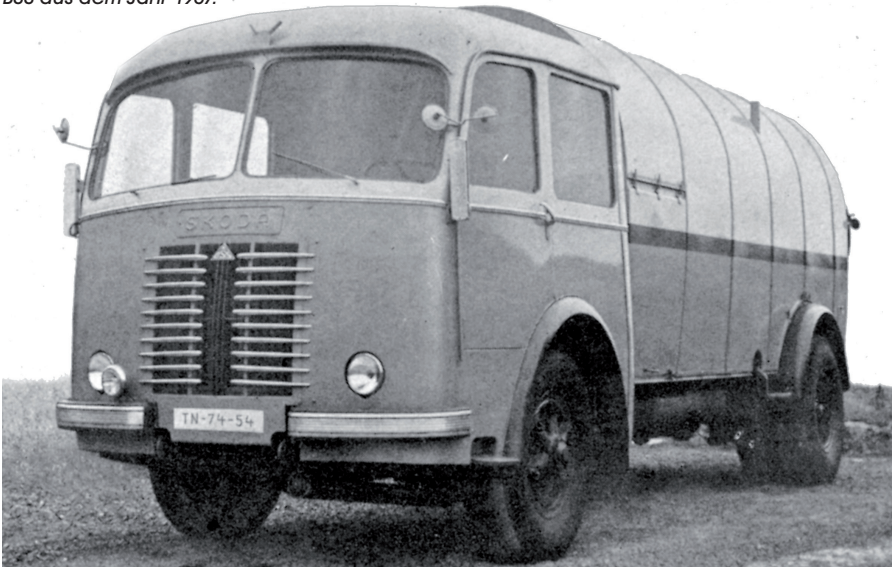
Müllsammelwagen Skoda 706 ROK auf Niederrahmen-Chassis, mit Buskabine und Aufbau von BSS aus dem Jahr 1957.
