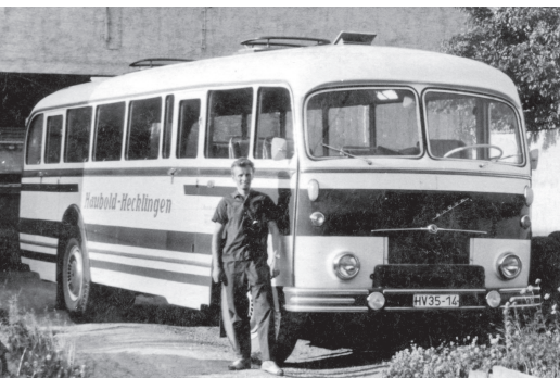
RO-Linienbus eines privaten Fuhrunternehmens mit H6B-Motor und optischen Retuschen. (Foto: Haubold)
