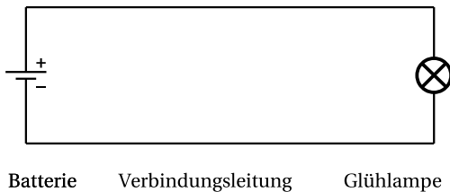
Bild 1.2 Elektrische Bauelemente werden durch Symbole dargestellt. Ihre Verschaltung ist durch Verbindungslinien festgelegt. Verbindungslinien sind keine Leitungen, insbesondere besitzen sie weder eine Ausdehnung noch einen Widerstand.
